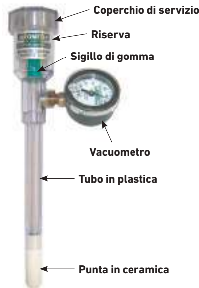
Componenti del tensiometro
